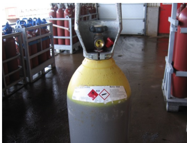
Specialacetylen med DMF i stället för aceton. Denna flaska är märkt med gult flaskbröst som betyder "giftig gas". Här måste man läsa på etiketten för att veta att det är acetylen.
